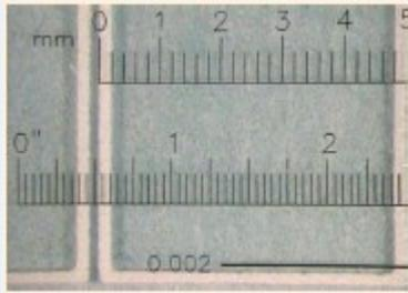
**Abb. 1:** Bildausschnitt von einem 25 x 25 Chip-Array über einen 8" Wafer. Der Ausschnitt zeigt ein 5 mm x 5 mm Sensorglas mit einem 200 µm gedrucktem Dichtungsband mit EPO-TEK und einem Abstand von 150 µm zum nächstgelegenen Sensorglas.
